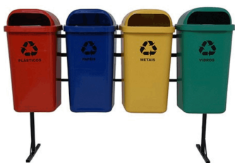
CONJUNTO 4 COLETORES DE 50 LITROS Dimensões em mm Altura: 1190 - Largura: 1820 - Profundidade: 430 Estrutura em aço carbono retangular 30 x 20 mm Coletores em PP (polipropileno) Capacidade total: 200 litros - Peso total: 22 kg Cores: amarelo - azul - cinza - marrom - verde - vermelho
