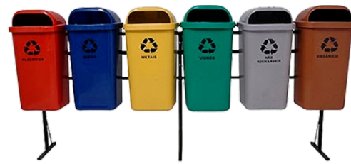
CONJUNTO 6 COLETORES DE 50 LITROS Dimensões em mm Altura: 1190 - Largura: 2368 - Profundidade: 430 Estrutura em aço carbono retangular 30 x 20 mm Coletores em PP (polipropileno) Capacidade total: 300 litros - Peso total: 32,6 kg Cores: amarelo - azul - cinza - marrom - verde - vermelho
