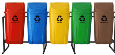
CONJUNTO 5 LIXEIRAS BASCULANTES DE 60 LITROS Dimensões em mm Altura: 930 - Largura: 2100 - Profundidade: 430 Estrutura em aço carbono retangular desmontável Coletores em PP (polipropileno) Capacidade total: 300 litros - Peso total: 18,7 kg Cores: amarelo - azul - cinza - marrom - verde - vermelho
